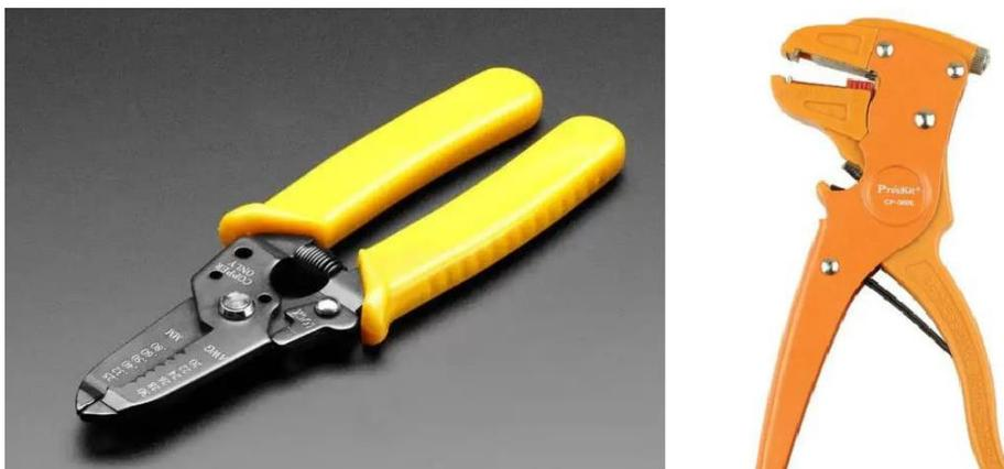
图 2.5 剥线钳和鸭嘴钳图片
