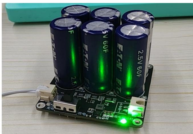
用万用表检测放电接口两端的电压，检测到电压值在 7.38V，符合  $7.4V \pm 0.1V$  的标准。注意：不同的超级电容组可能因为些许误差，以及万用表也会有一定的误差，故每个人检测出来的电压值可能不同，但都符合该精度要求。
